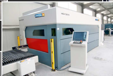
Последно поколение „Fiber“ лазерна машина за разкрой
